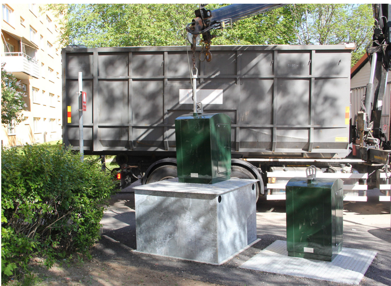
Tömning av underjordsbehållare. FOTO: TOMAS THERNSTRÖM, RAMBOLL
